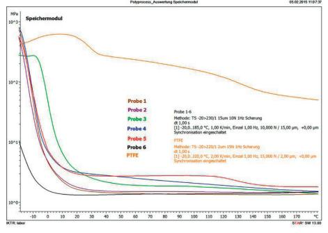
»1 Materialcharakterisierung – Temperaturabhängigkeit des Speichermoduls
