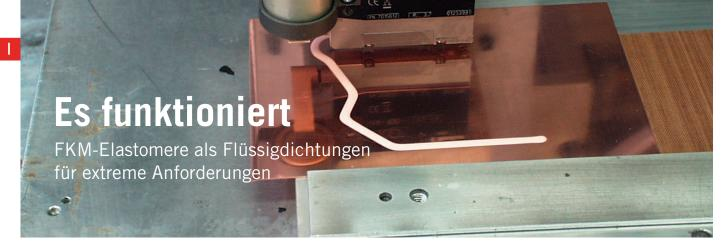
BRANCHENÜBERGREIFEND\_FLÜSSIGDICH-TUNGEN/WERKSTOFFE — Wenn über Flüssigdichtungen gesprochen wird, liegt der Fokus werkstoffseitig selten auf FKM. Für die Abdichtung einer HT-PEM-Brennstoffzelle erwies sich dieser Werkstoff flüssig aufgetragen aber als Lösung — ein Projektbericht.
