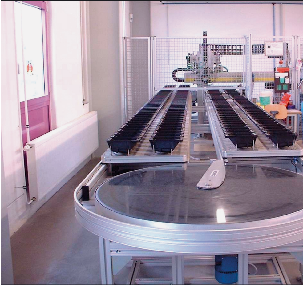
Der Maschinenpark bei Polyprocess mit insgesamt 15 Anlagen ist im Durchschnitt vier Jahre alt; das Bild zeigt eine CNC-gesteuerte Polyurethanschäummaschine mit Umlaufband
