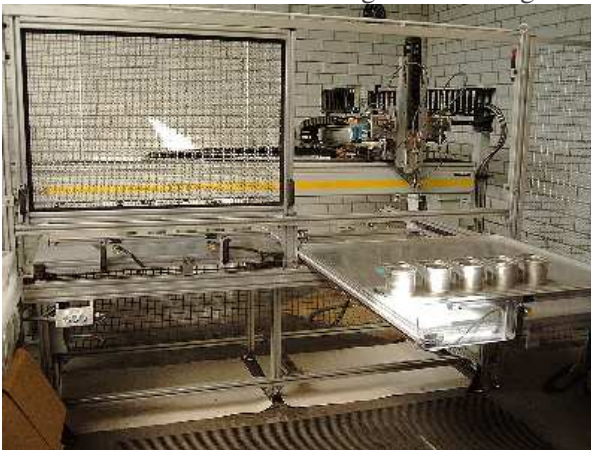
Abb.2: Misch- und Dosieranlage mit 3 Achsen und Schiebtischlösung
