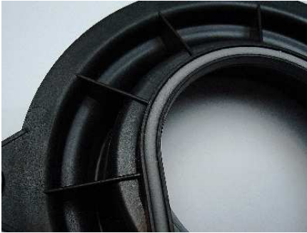
Abb. 7 Zahnriemenabdeckung mit Silikon-Schaumdichtung
