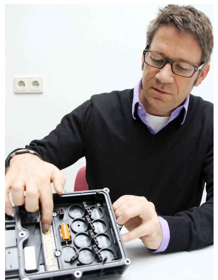
Frank Schuhmann zeigt eine Vergussmasse mit Silikon gel zum Schutz von Elektronikbauteilen wie diesem Steuergerät.
