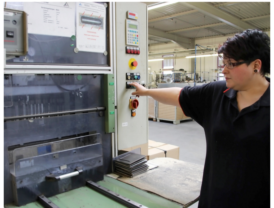
Nicole Bonic hat ein Bauteil zur Kontrolle in das Gerät geschoben, das mit Hilfe von Luftdruck die Dichtigkeit der Schaumasse prüft.
